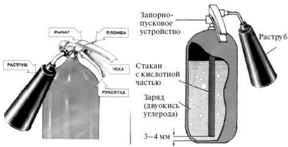
Рис. 7. Углекислотный огнетушитель ОУ-2
