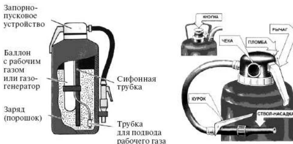
Рис. 8. Порошковый огнетушитель со встроенным газовым источником давления
