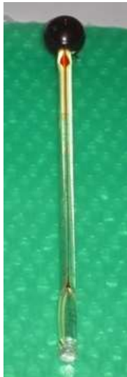
Рис. 5. Кататермометр, прибор для измерения скорости движения воздуха
