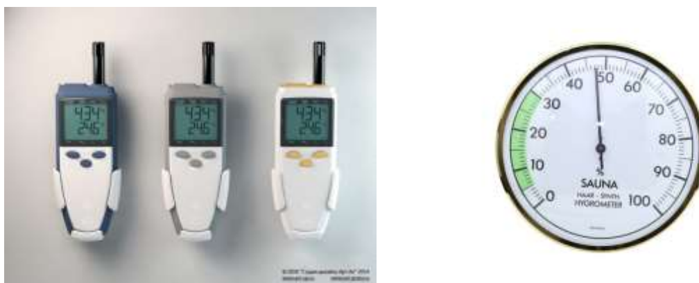
Рис. 2. Гигрометры, приборы для измерения влажности воздуха
